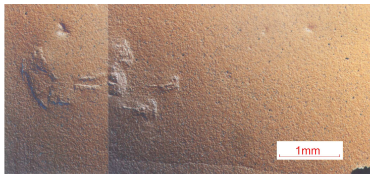
Abbildung D.8: Übersicht über die bei geringen Geschwindigkeiten entstandenen Risse
